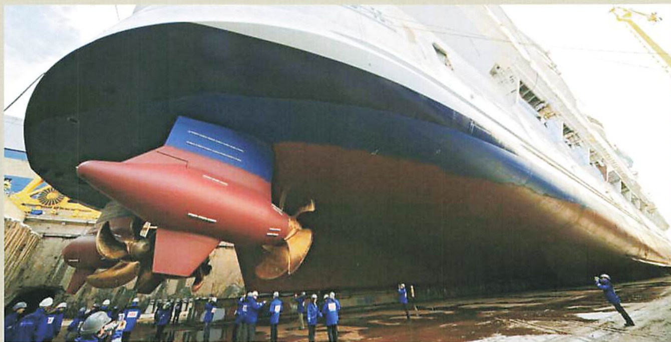
世界最大級のクルーズ客船「オアシス・オブ・ザ・シーズ」の巨大なポッド推進器。写真では右舷機は前進方向に、左舷機は真横にスクリュープロペラが向いている。
