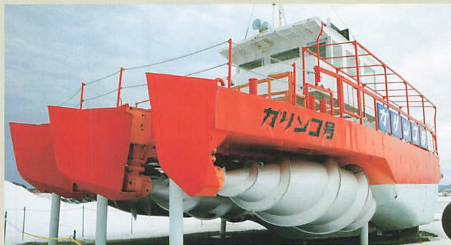
推進器としてアルキメディアン・スクリューを取り付けた北海道紋別で活躍した流氷観光船「ガリンコ号」。
