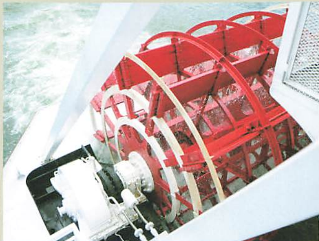
「ミシガン」の船尾に取り付けられている外輪推進器。
